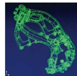
CAD/CAM環境を整備し、3Dモデリングと加工プログラミングを自社で対応し、精度の高いNCデータを使用しております。
